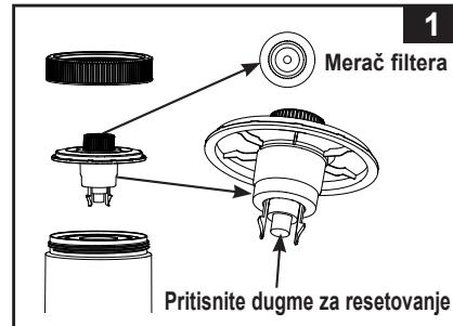
**NAPOMENA:** Da biste osigurali pravilno očitavanje merača filtera, uklonite sve dodatke (čistač površine, svetla, prskalicu, automatski čistač itd) sa ulazne i izlazne linije filtracionog sistema. Pogledajte odeljak „Vodič za rešavanje problema“ za detalje.
