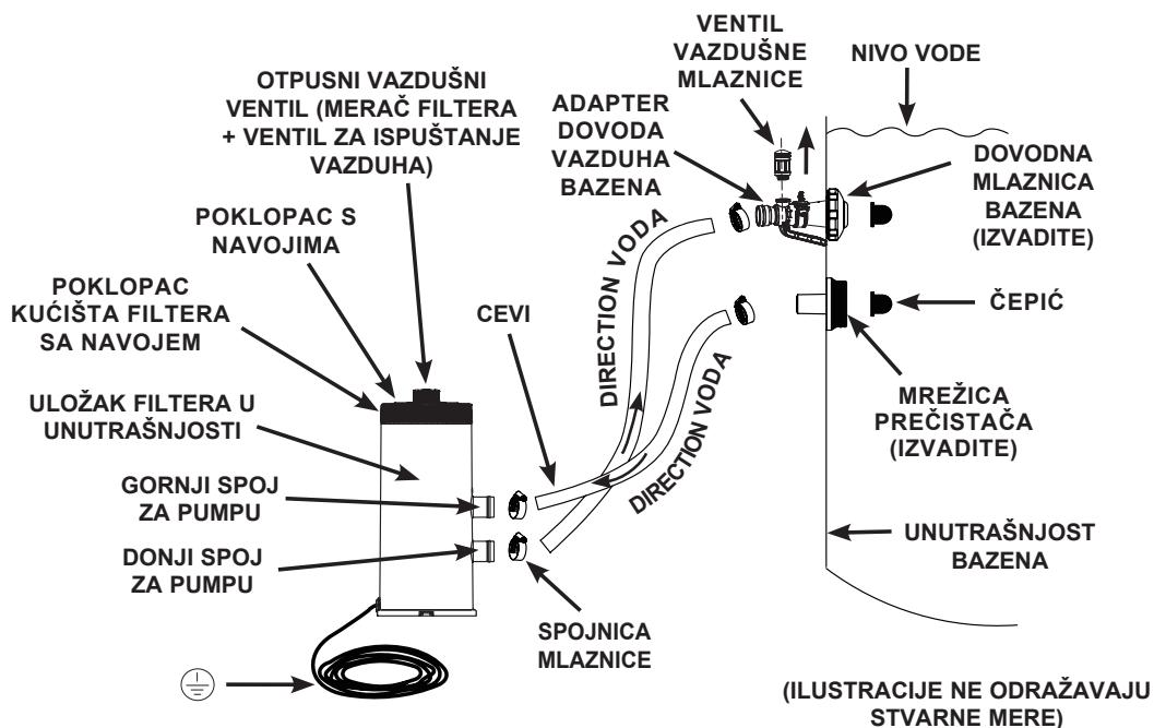
Utikač kabla za napajanje za 220-240 volti izvora električnog napajanja filter pumpe mora biti postavljen najmanje 3,5 m od zidova bazena. Proverite kod lokalnih vlasti odgovarajuće standarde i zahteve u vezi »električne instalacije bazena i ostale opreme u bazenima«. Sledeća tabela služi samo za upoređenje:
